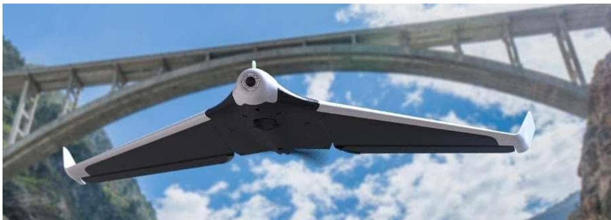
Дрон-самолет Discоспособен развивать высокую скорость, оснащен качественной FPV камерой с подвесом, умеет самостоятельно взлетать и приземляться. Передача видеосигнала происходит на смартфон пилота, можно использовать комплектную VR-маску. И, самое главное, время полета достигает 45 минут. С максимальной скоростью 80 км/ч
