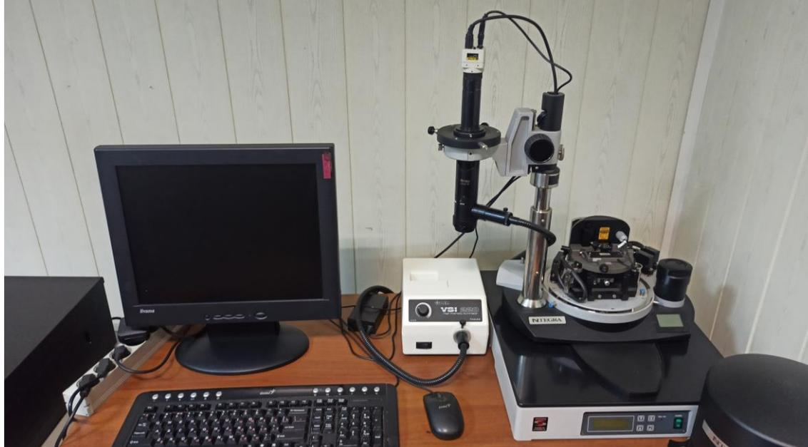
**NTEGRA AURA** является высокоэффективным исследовательским комплексом методами СЗМ в вакууме, позволяя выходить на рабочий режим значительно быстрее нежели аналогичные высоковакуумные системы, при этом вакуум, обеспечивающий десятикратное увеличение добротности, достигается всего за 1 минуту! Компактность и легкость в обслуживании являются так же серьезными преимуществами прибора.
