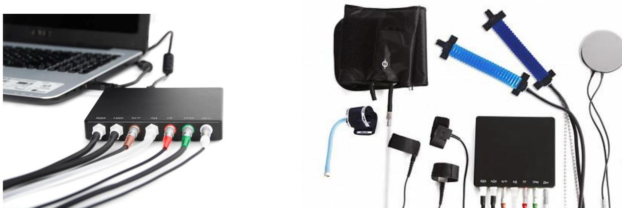
Профессиональный компьютерный полиграф последнего поколения с функциональным ПО, современным блоком регистрации сигналов и датчиками. Полиграф имеет широкий набор модификаций и дополнительных модулей для решения любых задач. Впервые в «Диана-07» применены пневмо-датчики дыхания. Особенность конструкции таких датчиков позволяет решить проблемы недостаточной линейности, устойчивой регистрации апноэ, надёжной
